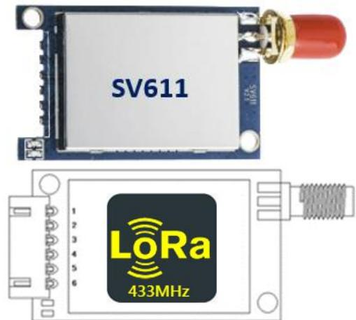
Il modulo SV611 si collega con i cavi di collegamento in dotazione e si fissa alla chiusura del contenitore a mezzo terminale SMA, praticando un foro da 6mm. I ponti a saldare posizionati in vicinanza del connettore 6 poli, lato saldature, consentono di collegare una delle linee seriali RS232 disponibili. Attenersi ai suggerimenti pratici elencati nel paragrafo precedente.
