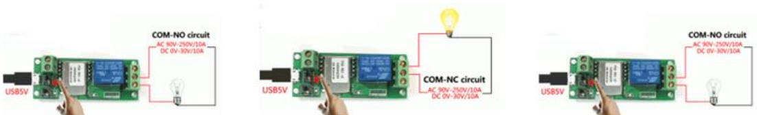
Funzionamento monostabile OFF/ON/OFF del relè PSA-B01-GL
