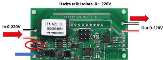
Alimentare la scheda con una tensione compresa tra 5 e 24Vcc (freccia blu). Dissaldare i ponti smd Zero Ohm (cerchiati in rosso). Assicurarsi che i collegamenti + e - della Vcc siano collegati correttamente
