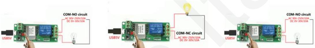
Funzionamento monostabile OFF/ON/OFF del relè PSA-B01-GL
