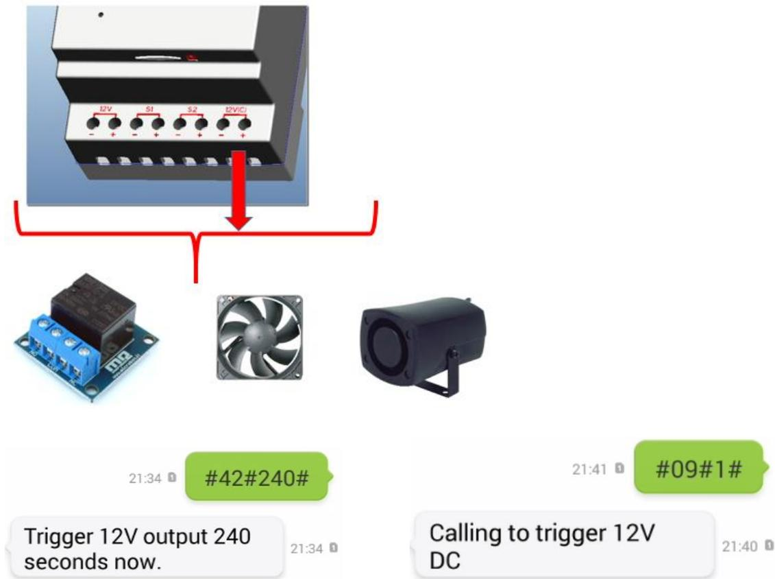
Attivando prima la funzione #09#1# e *inviando, dopo*, una chiamata al modulo GSM, l'uscita 12VC si attiva per un periodo limitato, come da precedente configurazione della funzione #42#.
