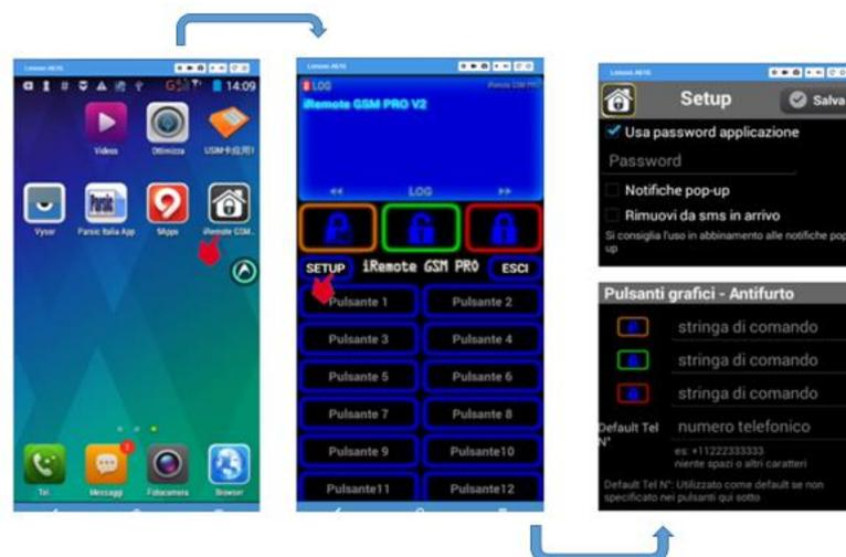
Si apre il pannello di controllo da cui potrete operare per l'inserimento dei codici necessari al telecomando del controllore GSM. Nel primo riquadro, spuntando gli appositi FLAG, potrete:
