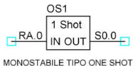
La durata ON dell'impulso d'uscita del blocco monostabile, dipende dalla lunghezza del listato assembler. Più righe saranno contenute nel listato, più lungo sarà il tempo ON dell'impulso d'uscita.
