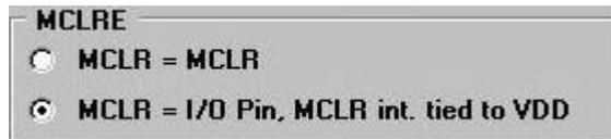
**MCLR ( Master Clear)** : selezionando **MCLR = MCLR** le operazioni di reset del micro avvengono collegando elettricamente questo terminale al circuito esterno.
