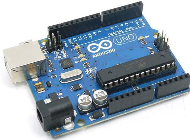
Con Arduino si possono realizzare in maniera relativamente rapida e semplice piccoli dispositivi come controllori di luci, di velocità per motori, sensori di luce, temperatura e umidità e molti altri progetti che utilizzano sensori, attuatori e comunicazione con altri dispositivi. È fornito di un semplice ambiente di sviluppo integrato per la programmazione. Tutto il software a corredo è libero, e gli schemi circuitali sono distribuiti come hardware libero.
